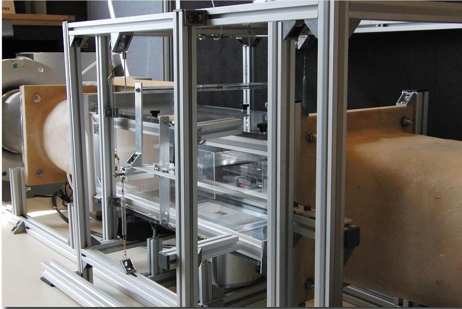
Figure 35. Vue générale de l'expérience avec le tablier de pont profilé
