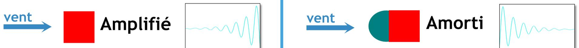
Dans le cas des ponts, les formes sont plus compliquées que le prisme carré. Les profils sont plus allongés et le mouvement se traduit principalement par une torsion.
