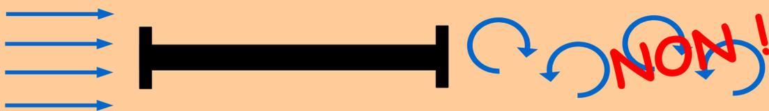
Dans l'expérience proposée, nous avons reproduit en la simplifiant la forme du tablier. Il s'agit d'un H très aplati de rapport hauteur sur largeur de 1 sur 5. Un tronçon rigide est monté mécaniquement avec la possibilité d'osciller en torsion, comme le tablier du pont réel. L'expérience démontre que cette forme en H aplati est mauvaise. Alliée à la souplesse du pont, c'est elle qui est la cause de l'accident.
