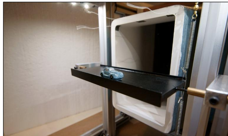
Car dès qu'un petit angle de torsion est initié, par exemple par une rafale de vent, la structure du pont tend à ramener sa position à l'horizontale. Ici ce sont les deux ressorts qui jouent ce rôle. Sauf qu'avec cette forme de tablier, le rappel élastique s'effectue avec un petit retard à chaque oscillation. La durée du retard augmentant avec la vitesse du vent, l'énergie transmise par le vent est de plus en plus grande.
