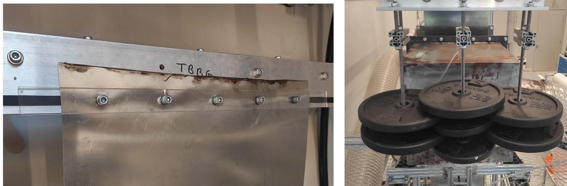
**Figure 3.4** – A gauche : Encastrement de la première extrémité de la bande. A droite : Système de contrepois réglable attaché à la seconde extrémité.
