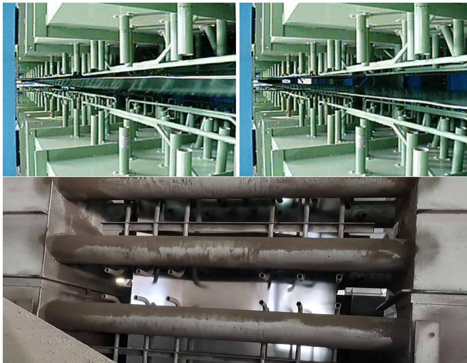
**Figure 1.4** – En haut : deux extraits d’une vidéo de flottement, à une fréquence estimée d’environ  $2.4 \text{ Hz}$  dans l’usine de Košice, République Tchèque. En bas : extrait d’une vidéo de flottement, dans un autre mode, à une fréquence estimée à  $3.80 \text{ Hz}$ , dans l’usine de Piombino, Italie.
