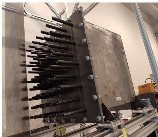
**Figure 3.6** – Photo de l'un des deux caissons de soufflage, équipé de toutes les buses.
