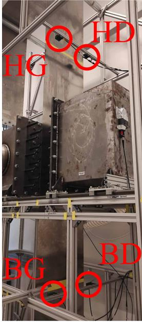
**Figure 3.9** – Photographie des capteurs de déplacement.
